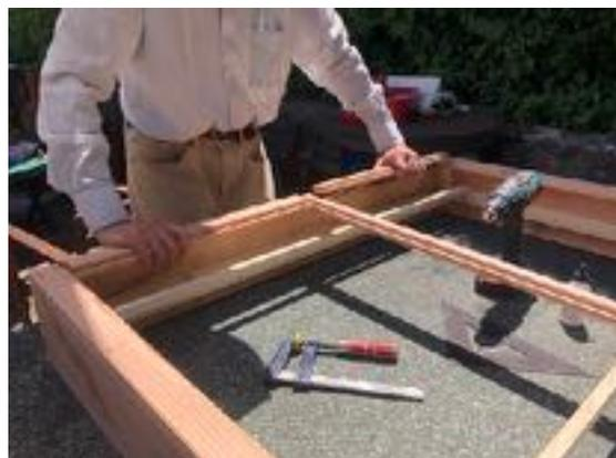
Caisson du capteur prêt à recevoir l'isolation
